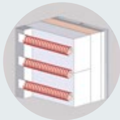
Trójwarstwowa konstrukcja ścian serii KE-SH
