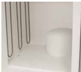
Głowica procesu z zasilaniem gazem poprzez trzon pieca chroni komorę pieca przed zanieczyszczeniami, względnie zapobiega wzajemnym oddziaływaniom chemicznym między wsadem a elementami grzewczymi
