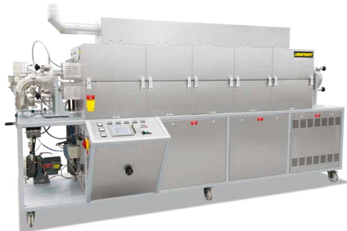
RS 250/2500/11S ze sterowaniem pięciostrefowym, do wyżarzania drutów w warunkach wysokiej próżni lub w atmosferze gazów ochronnych, z wymuszonym chłodzeniem i kominem na zużyte powietrze
