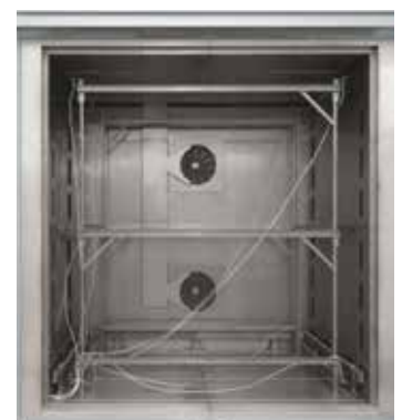
Wkładany stojak pomiarowy do pieca komorowego z obiegiem powietrza N 7920/45 HAS
