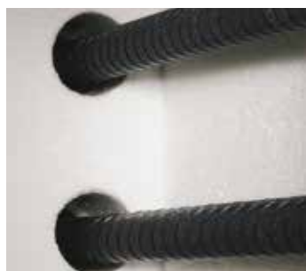
Komora pieca z materiałem włóknistym o wysokiej jakości i prętami grzewczymi z SiC po obu stronach
