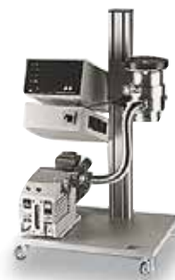
Pompa próżniowa umożliwiająca pracę przy 10^{-5} mbar
