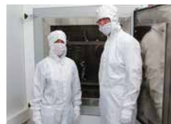
Piec na powietrze obiegowe NAC 250/65 w wersji przeznaczonej do pomieszczeń czystych klasy 100, z drzwiami w pomieszczeniu czystym
