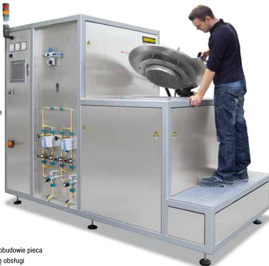
SVHT 9/24-W z nagrzewaniem wolframowym
