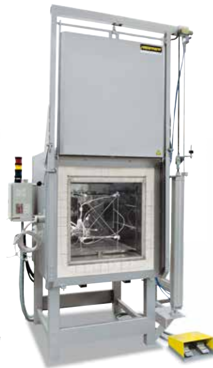
Stojak pomiarowy do wyznaczenia równomierności temperatury
