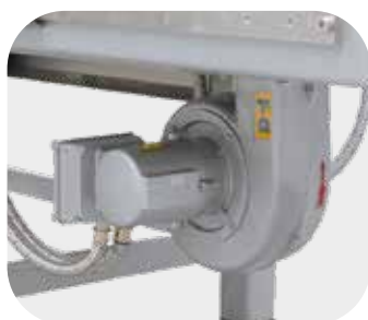
Dmuchawa chłodząca do przyspieszonego schładzania przy zamkniętej pokrywie
