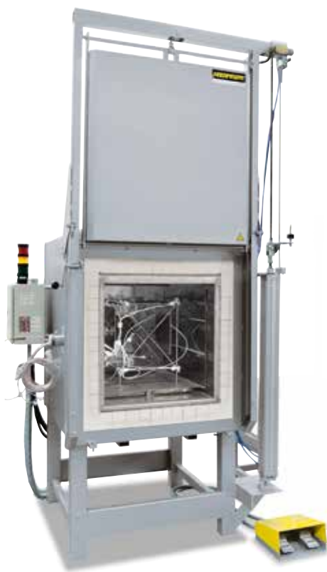
Stojak pomiarowy do wyznaczenia równomierności temperatury
