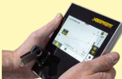
Rejestracja danych procesowych podłączonego kontrolera za pomocą pamięci USB.
