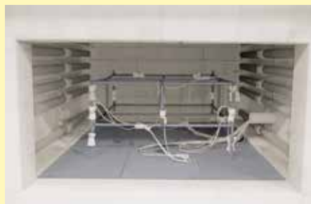
Konstrukcja pomiarowa w piecu do wyżarzania
